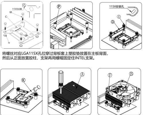
将螺丝对应LGA115X孔位穿过背板上塑胶垫放置在主板背面, 然后从正面放置胶柱、支架再用螺帽固定住INTEL支架。
