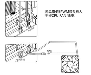
将风扇4针PWM接头插入主板CPU FAN 插座。
