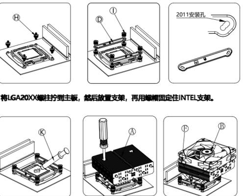
将LGA20XX螺柱拧到主板, 然后放置支架, 再用螺帽固定住INTEL支架。
