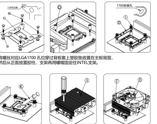
将螺丝对应LGA1700孔位穿过背板上塑胶垫放置在主板背面, 然后从正面放置胶柱、支架再用螺帽固定住INTEL支架。
