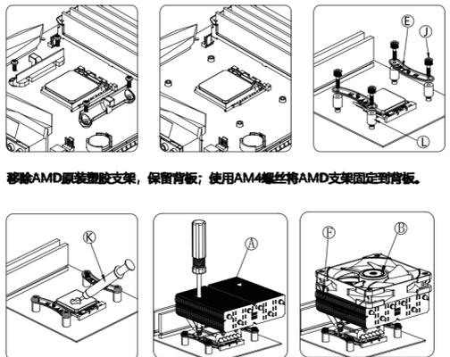
移除AMD原装塑料支架, 保留背板; 使用AM4螺丝将AMD支架固定到背板。
