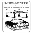
用螺丝刀拆除主板原装塑胶支架、背板,拆除散热器上预装的 螺母x4、背板、支架x2。
